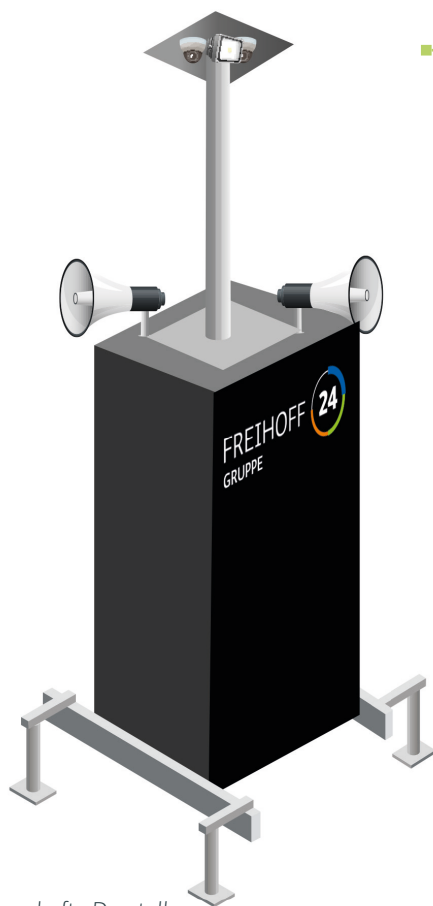
Schemenhafte Darstellung einer ProtegoVideoMast-Anlage
