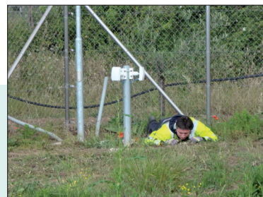
Markus Piendl testet die Funktion eines Mikrowellen-Detektors im Bereich des Perimeters und stellt dabei das Täterverhalten nach
